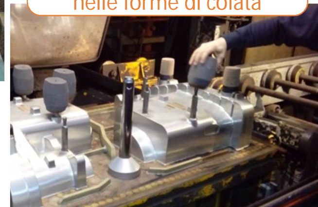
Operazione di posizionamento maniche nelle forme di colata
