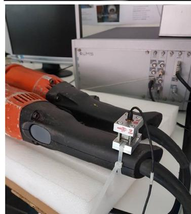
Molatrici strumentate per analisi vibrazioni
